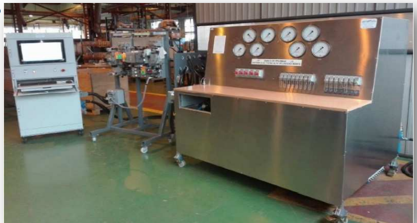
Banco de pruebas de componentes y sistema de freno de los trenes de alta velocidad de RENFE series 103,104, 114 y 253
