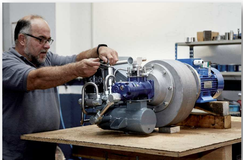
Banco de pruebas de componentes y sistema de freno de los trenes de alta velocidad de RENFE series 103,104, 114 y 253
